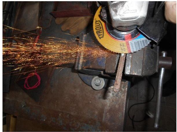
*Acero con alto contenido de carbono (elástico de amortiguador) Chispas cortas con abundantes chisporroteos*
