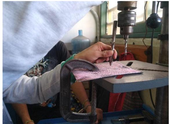
Al trabajar con esta herramienta eléctrica de corte se desprende viruta y se pueden generar riesgos como un giro imprevisto de la chapa, para ello usamos elementos de protección, fijamos la chapa con prensas, y evitamos el contacto con fillos, tales como, virutas y rebabas.
