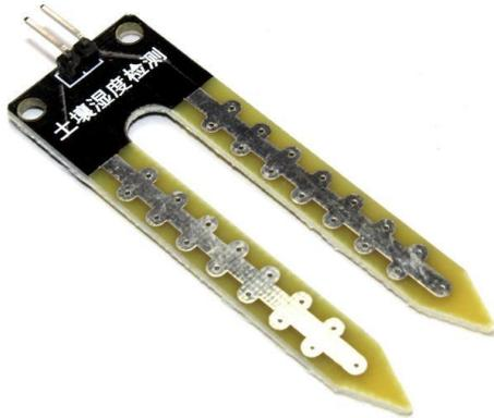
Funcionamiento: Este sensor tiene la capacidad de medir la humedad del suelo. Aplicando una pequeña tensión entre los terminales, hace pasar una corriente que depende básicamente de la resistencia que se genera en el suelo y ésta depende mucho de la humedad. Por lo tanto al aumentar la humedad la corriente crece y al bajar la corriente disminuye.
