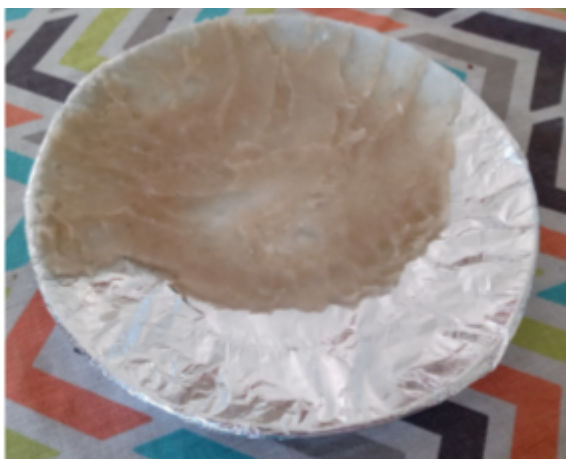
Figura 10: bioplástico producido a partir de almidón extraído de la papa.
