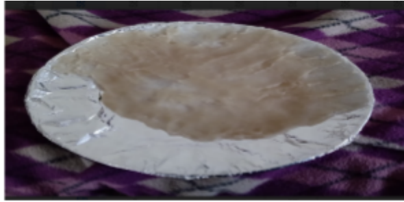
Figura 6: Bioplástico de almidón de papa antes de secar
