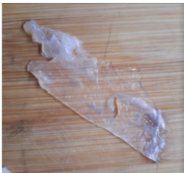
Figura 14: muestra de bioplástico de almidón de maíz sometida a agua hirviendo
