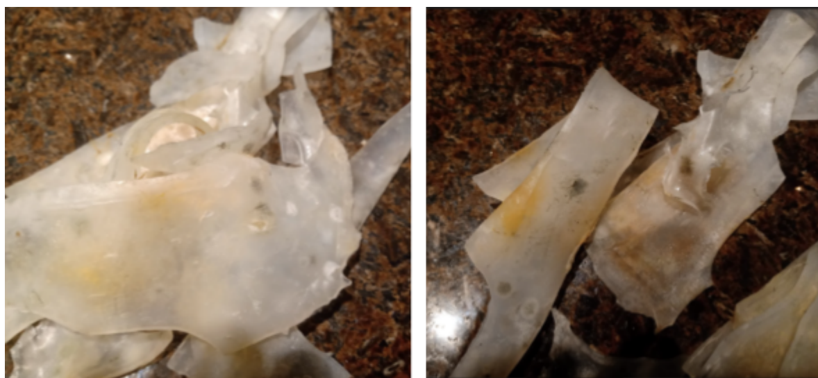
Figura 12: Restos de bioplástico de almidón de maíz luego de 10 días.
