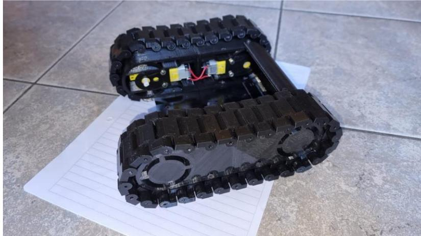
Se procede a ensamblar las partes del robot y dar comienzo a la programación. Luego se prueba físicamente cómo funciona y actúa en zonas con escombros, maderas y tierra. Se prueba la cámara y la transmisión en tiempo real. También se prueba el manejo a distancia en personas de diferentes edades, testeando en diez voluntarios sin conocimientos previos de robótica con un rango de edad de 15 años, 20 años, 30 años, 40 años, 50 años y 60 años.
