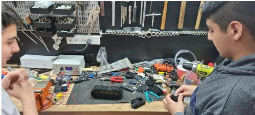
Seguidamente se agrega un módulo de comunicación por radiofrecuencia para poder realizar un control inalámbrico del robot por medio de un joystick de PlayStation 2. Para moverse e interactuar con el contexto se utilizaron moto reductores eléctricos, conocidos como “motores amarillos” de corriente continua, que son los actuadores frente al estímulo.
